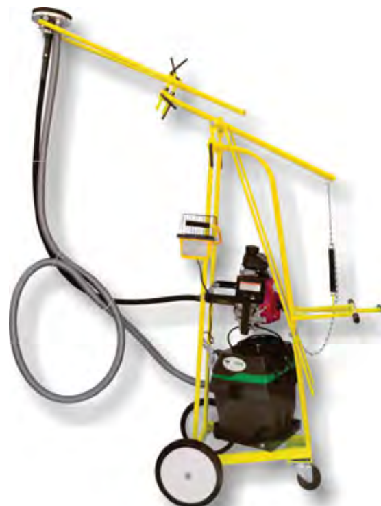
Esmeriladora para techo CG12G-DC7-H Modelo a gasolina CG12G con motor Honda de 3 HP, con sistema de recolección de polvo certificado por la HEPA.
